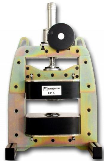
Bei dem Elektromagneten EP 5 wird die hohe Feldstärke im Luftspalt dadurch erreicht, dass die obere Feldspule zusammen mit dem Oberpol bewegt wird, so dass das Magnetfeld der beiden Spulen optimal wirkt.
