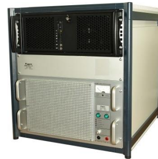
Geräteschrank des REMACOMP ® C - 100 mit Leistungsverstärker und Computer
