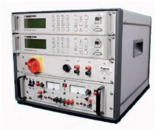
Geräteschrank der REMAGGRAPH® - REMACOMP® - Kombination C - 710 mit zwei elektronischen Fluxmetern EF 5
